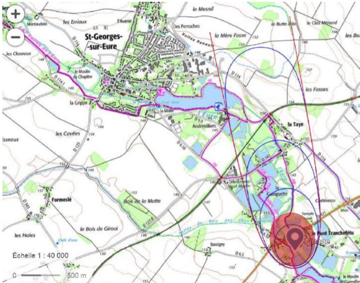
Figure 10. Zone appel et isochrones autour du site de Launay en pompage à 200 m 3 /h (d'après MAYER, 2019)
